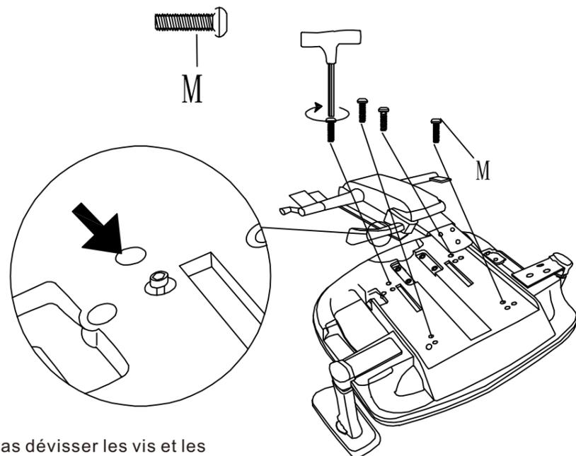
Note : Ne pas dévisser les vis et les rondelles préinstallées. Les positions des trous de de la base sont indiquées par les flèches dans l'image.
