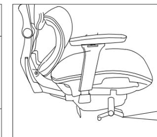
Coussin de siège réglable en avant et en arrière
