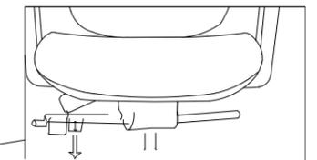
En poussant la poignée vers le bas permet de faire coulisser le le coussin d'assise de glisser de 60 mm vers l'avant. Relâcher la poignée permet de le bloquer dans la plage de mouvement.
