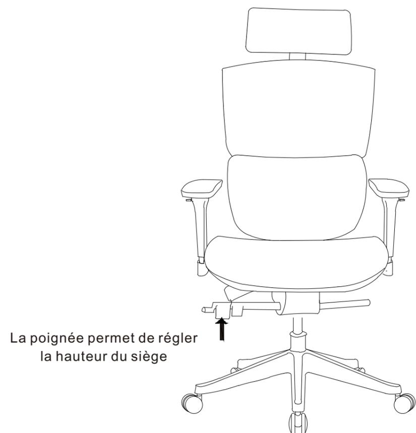
La poignée permet de régler la hauteur du siège
